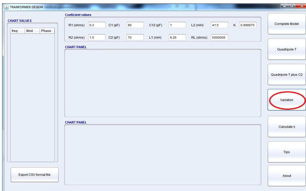
Figura 8 – Seleção da variação da curva da impedância de entrada de acordo com os coeficientes.
