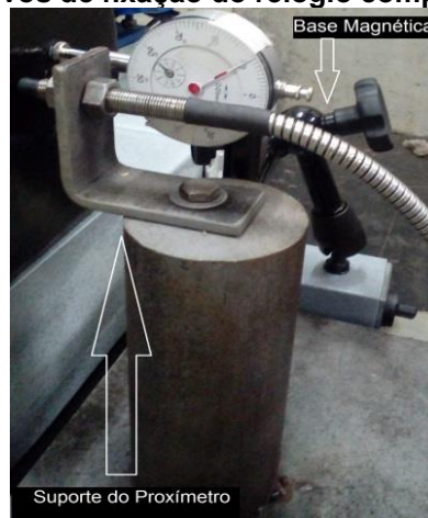
Figura 52– Dispositivos de fixação do relógio comparador e do proxímetro.
