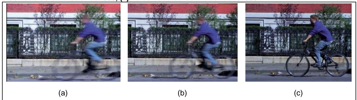
Figura 13 - Efeito do tempo de abertura do obturador. (a) Velocidade do obturador de 1/15 , (b) velocidade do obturador de 1/60 , (c) velocidade do obturador de 1/1000 .
