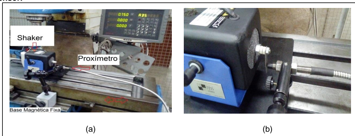
Figura 34– (a) Aparato para calibração do sensor de proximidade. (b) Detalhe do shaker e sensor.
