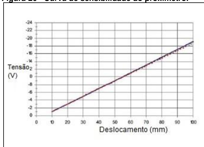
Figura 26 - Curva de sensibilidade do proximetro.
