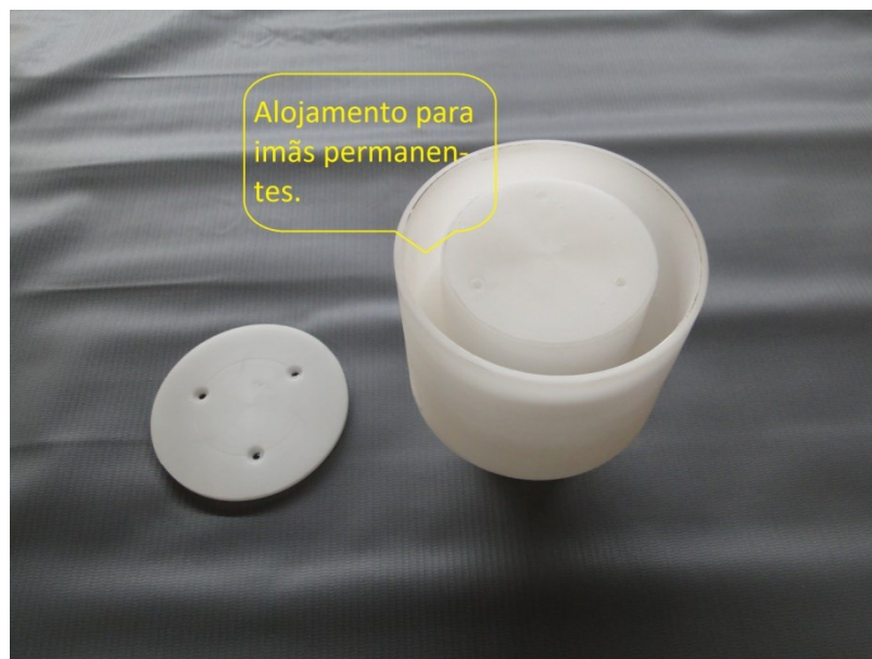
Figura 7 – Rotor para ímãs permanentes.
