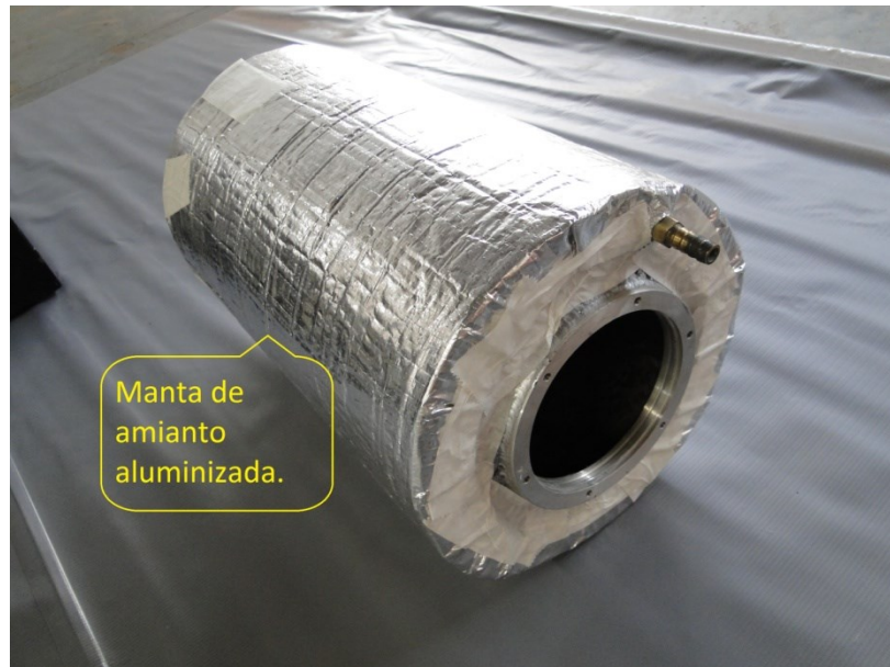
Figura 3 - Reservatório, detalhe do isolamento térmico.
