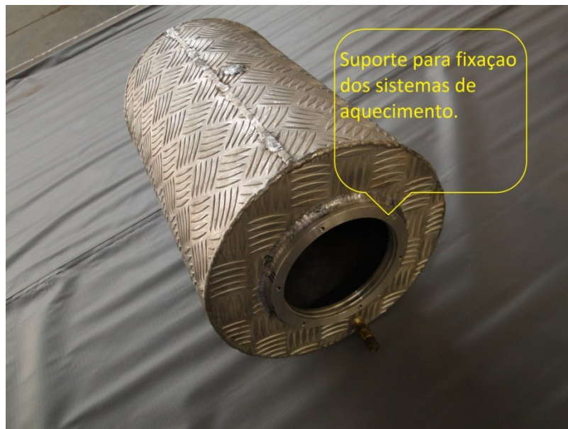
Figura 2 - Reservatório em alumínio.
