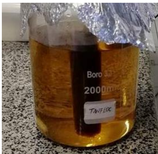
Figura 9. Imagem digital do sistema de diálise do TN obtida após o segundo dia de diálise. Fonte: Autor (2020).
