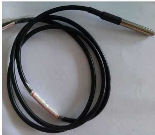
Figura 8 – Sensor de temperatura DS18B20 Fonte: Autoria Própria
