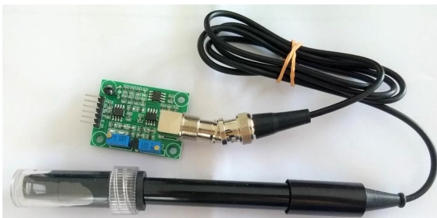
Figura 5 – Modelo do sensor de pH com módulo eletrônico Fonte: Autoria Própria
