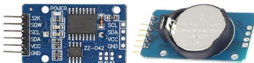
Figura 16 – Módulo RTC DS3231 Fonte: Autoria Própria
