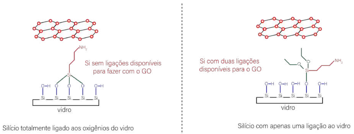
Figura 24 – Esquema do funcionamento do APTES como elemento de ligação entre FBG e GO.
