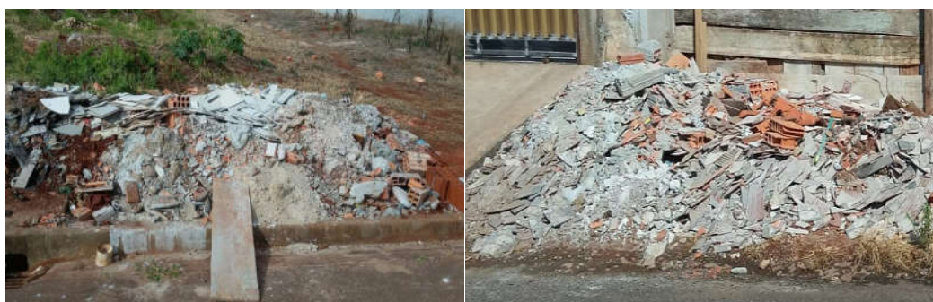
Figura 4.11 - Disposições inadequadas de RCC
