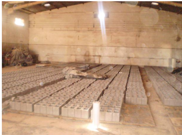
Figura 5 – Processo de cura dos blocos, empresa 01. FONTE: O AUTOR.
