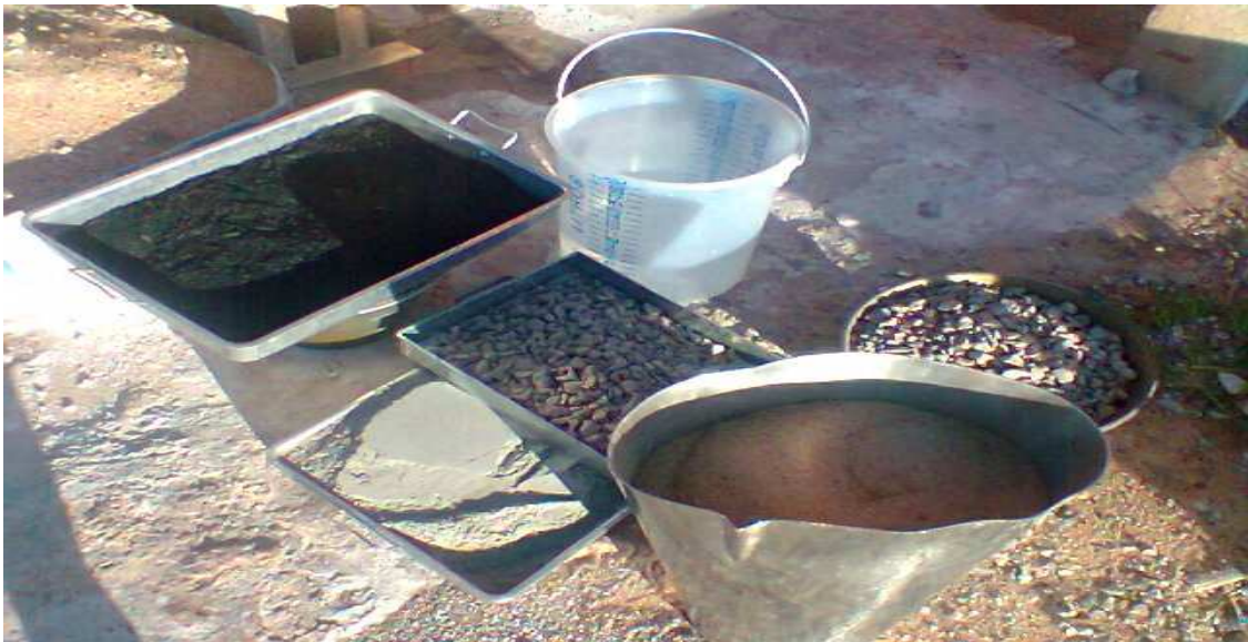
Figura 11 - Detalhe dos materiais obtidos na dosagem
