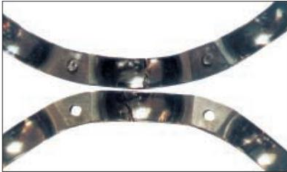
Figura 13: Gaiola de rolamento de uma carreira de esferas. Sintoma: Fratura.
