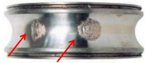
Figura 14: Anel interno de rolamento de uma carreira de esferas. Sintoma: Escamamento na pista.
