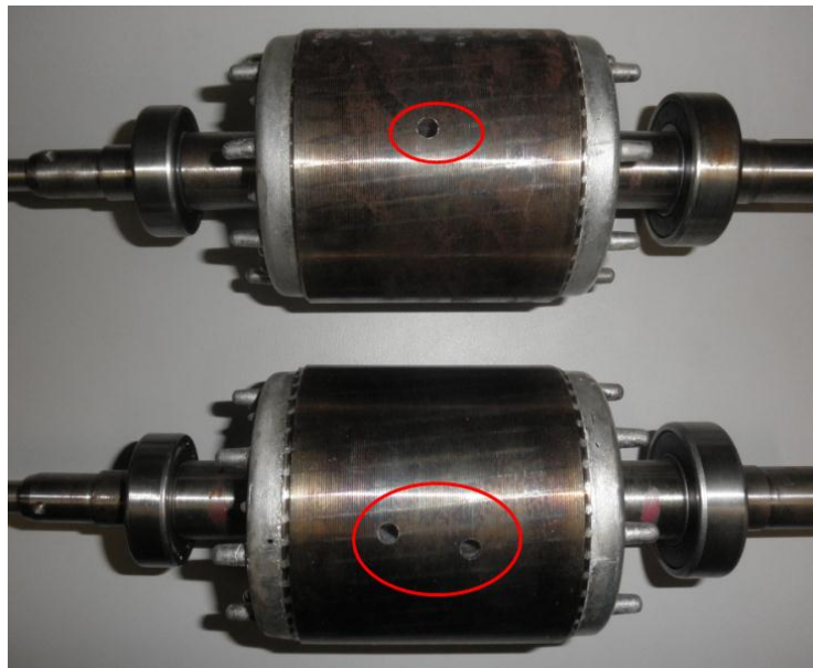
Figura 10: Rotores com uma e duas barras quebradas.
