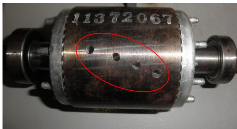
Figura 11: Rotor com 4 barras quebradas.
