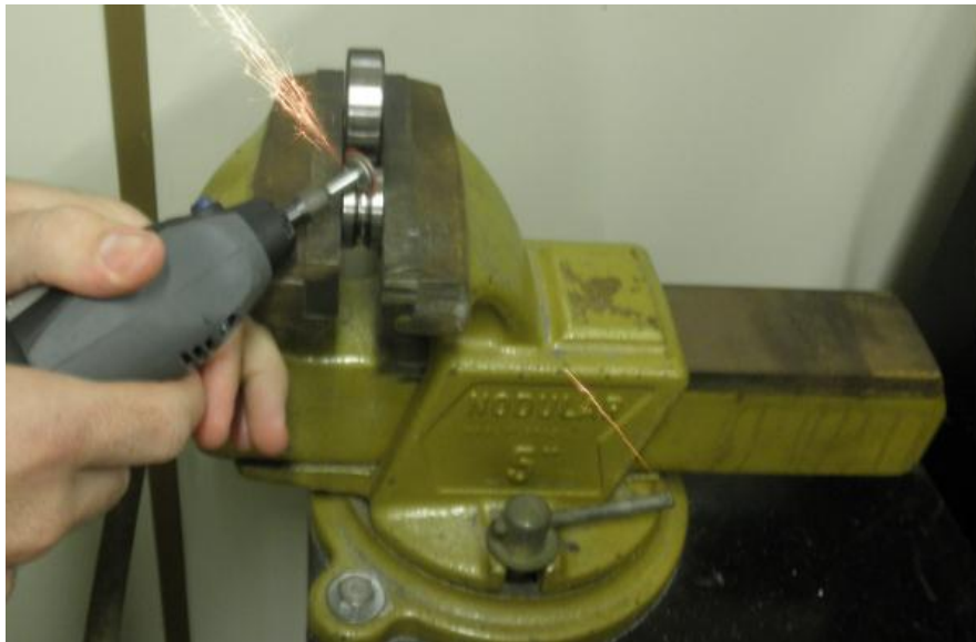
Figura 18: Inserção do defeito localizado no anel interno do rolamento.
