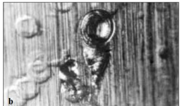
Figura 15 (a e b): Componente: Anel interno de rolamento de uma carreira de esferas. Defeito: Derretimento do material pela passagem de corrente elétrica.
