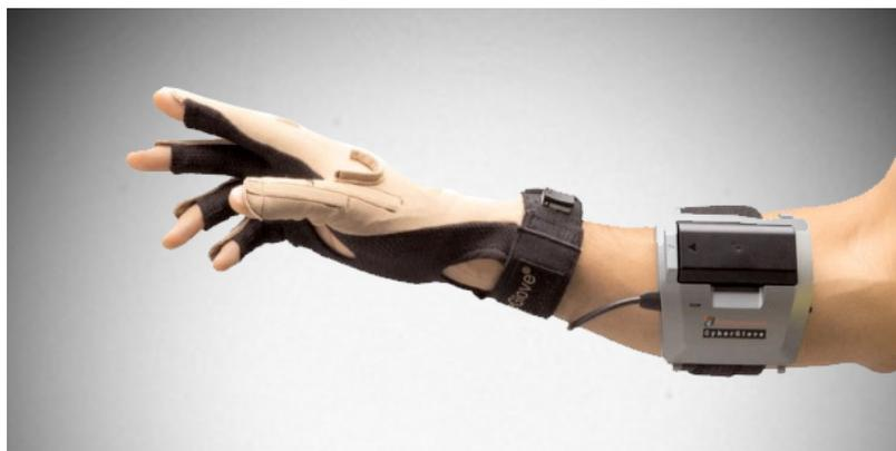
**Figura 2.2.** Dispositivo do tipo *DataGlove*
