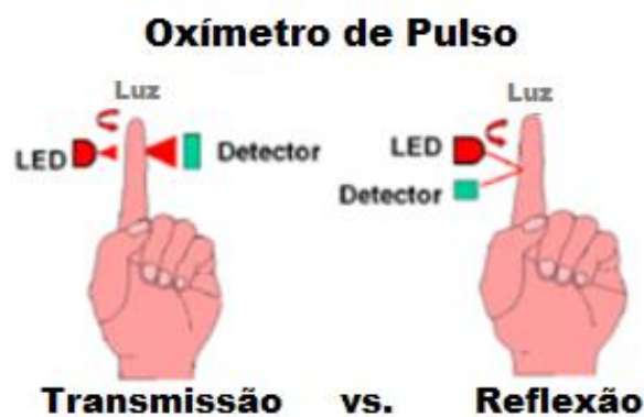
Figura 4– Modo Transmissão vs. Modo Reflexão
