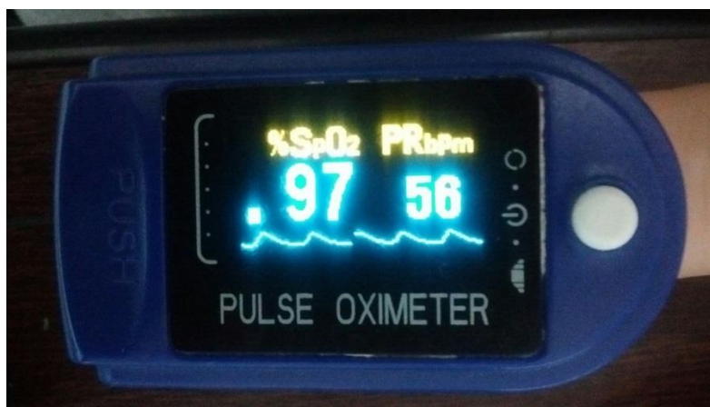
Figura 53 – Resposta de oxímetro comercial
