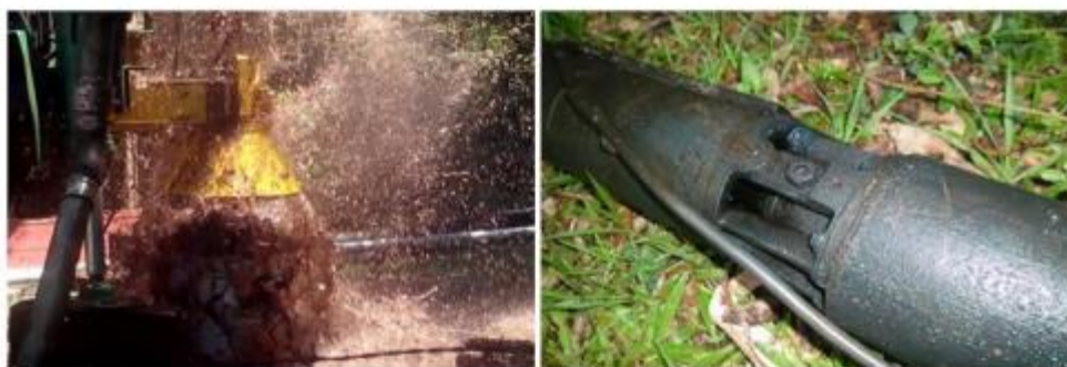
Figura 1 – Problemas gerados pelo elevado teor de metais pesados nas águas subterrâneas de Campina da Lagoa.
