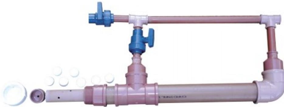
Figura 8 – Clorador desenvolvido para o uso no reservatório.
