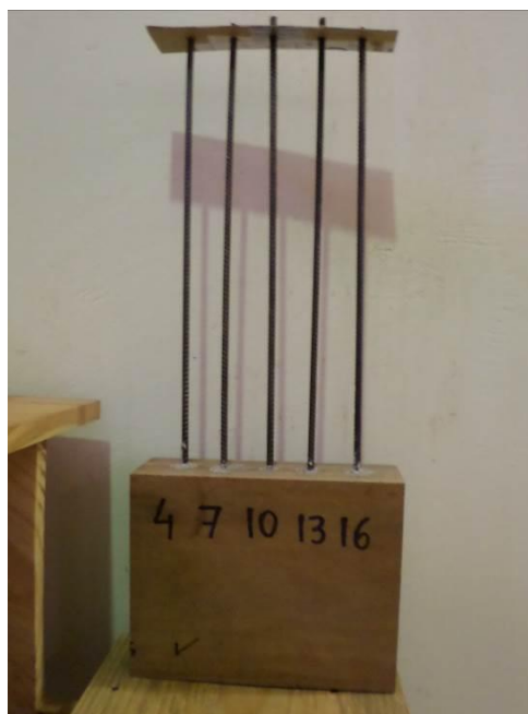
Figura 12 - Corpo de prova para o ensaio de arrancamento de barras coladas
