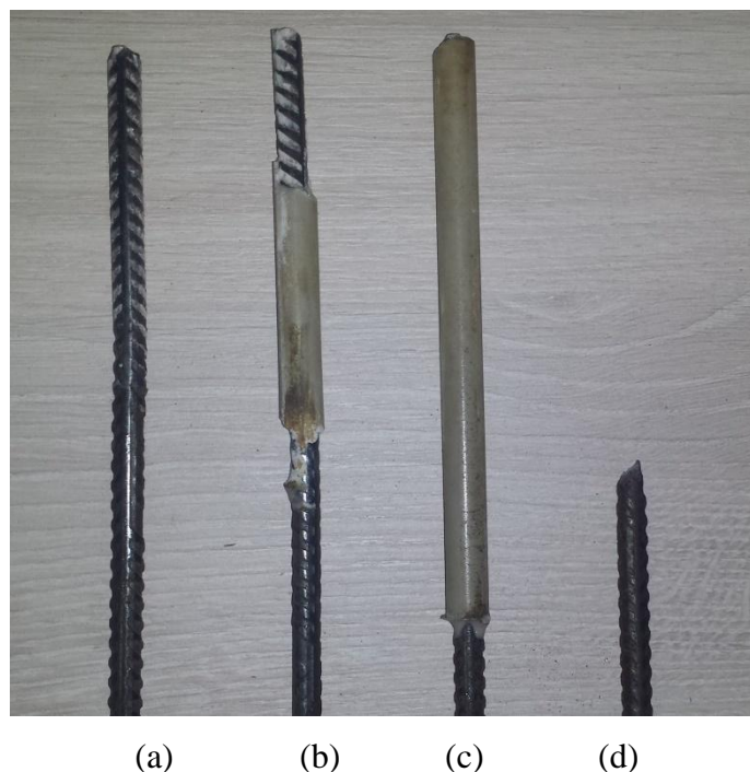
Figura 16 - Modos de ruptura, (a) da adesão no aço, (b) mista da adesão na madeira e no aço, (c) da adesão na madeira e, (d) no aço.
