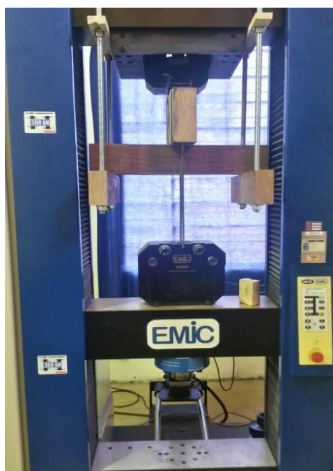
Figura 13 - Ensaio de arrancamento das barras de aço coladas em madeira
