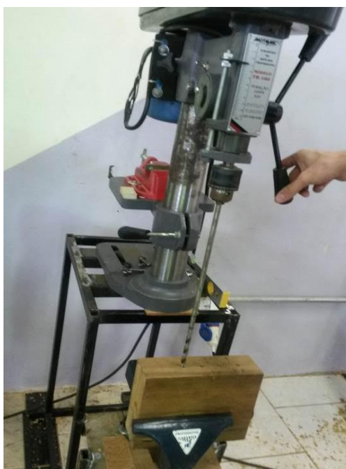
Figura 10 - Furação do corpo de prova em furadeira de bancada
