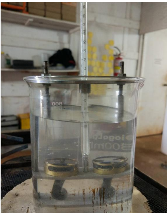
Figura 20 - Ensaio de ponto de amolecimento finalizado Fonte: Autoria própria (2017)
