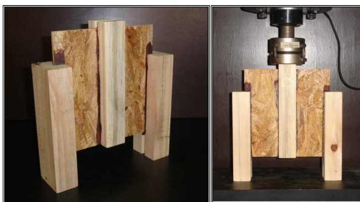
Figura 12–Corpo de prova de cisalhamento com reforço de alma e arranjo para ensaio
