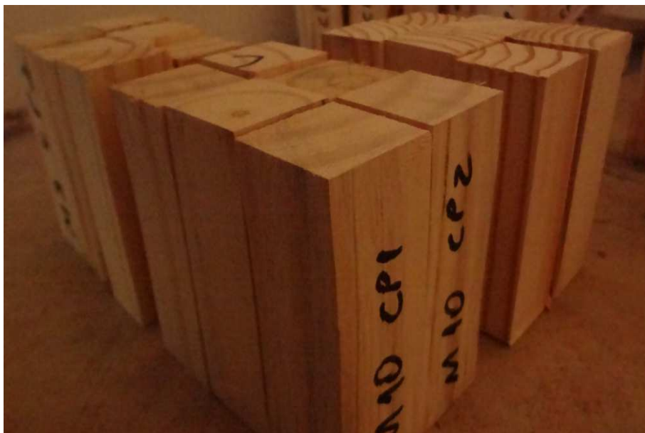
Figura 22 – Corpos de prova para ensaio de compressão paralela às fibras.
