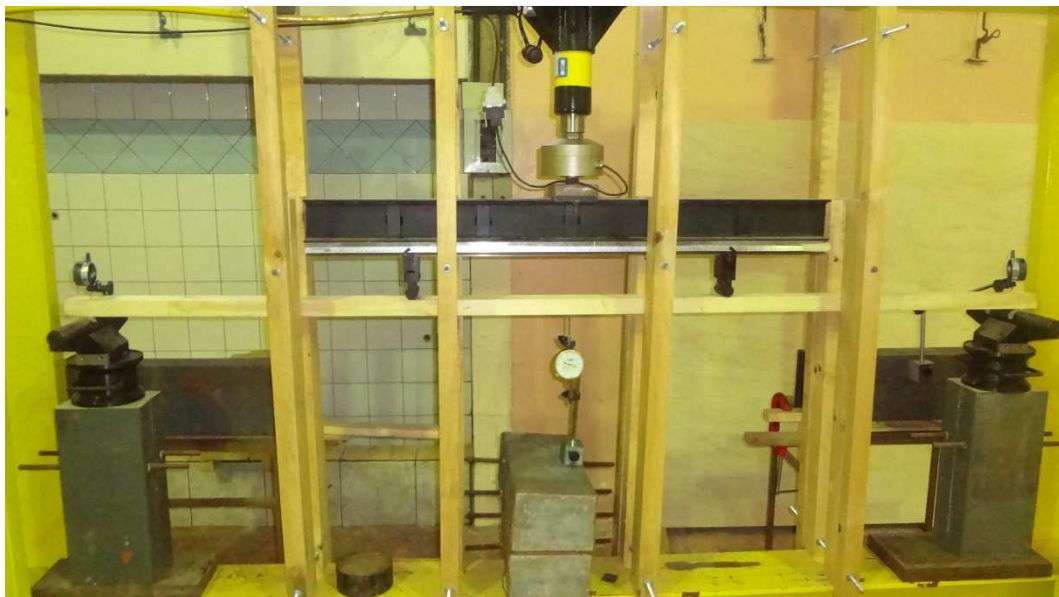
Figura 26 – Ensaio do módulo de elasticidade das mesas.
