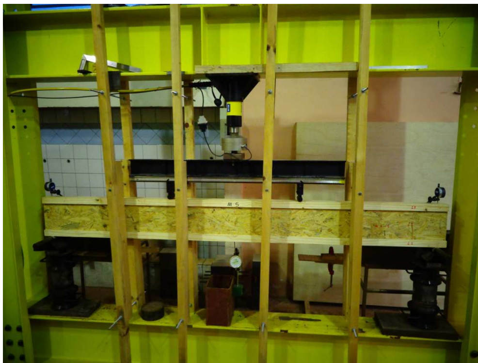
Figura 34 - Arranjo para ensaio das vigas.
