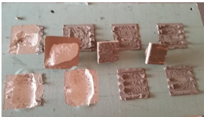
Fotografia 20 – Rupturas com o uso da AC III na chapa RU
