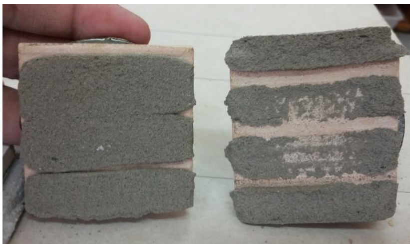
Fotografia 17 – Preenchimento tradicional e preenchimento no CP 7
