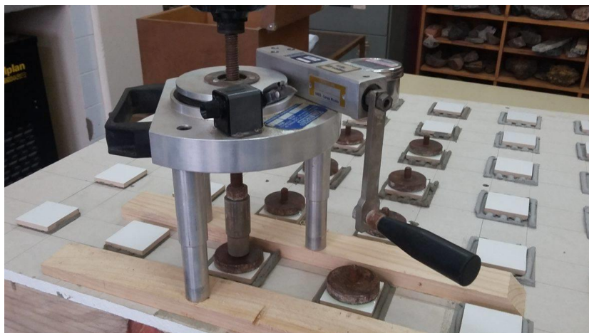
Fotografia 14 – Ensaio de aderência à tração
