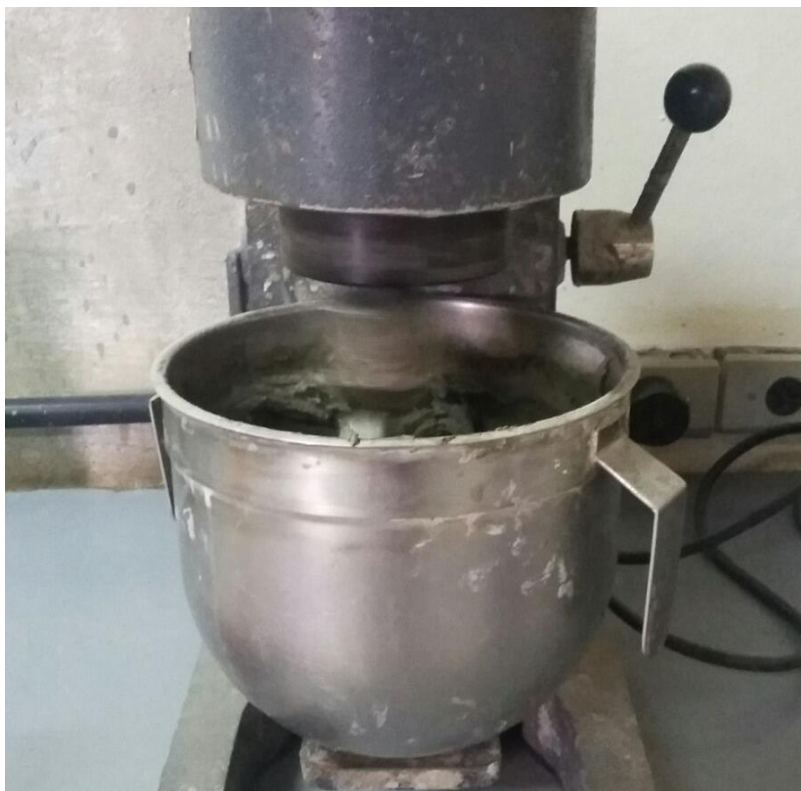
Fotografia 7 – Mistura da argamassa colante
