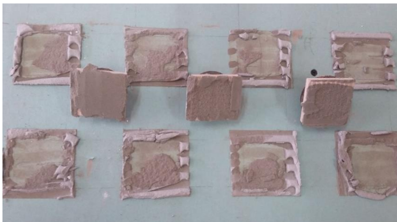
Fotografia 18 – Rupturas com o uso da AC I na chapa RU
