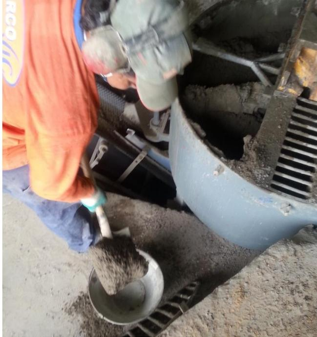
**Figura 30 - Concreto retirado do misturador para moldagem de C.P.**
