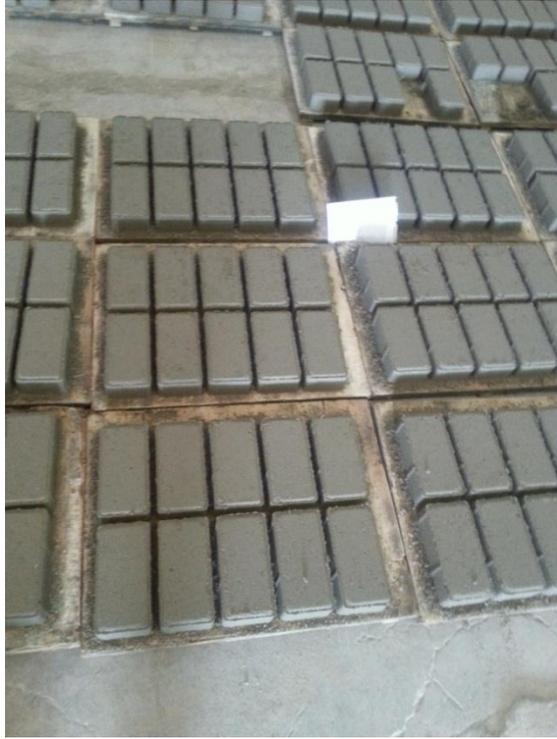
**Figura 27 - Blocos postos lado a lado em pallets em processo de secagem e cura.**
