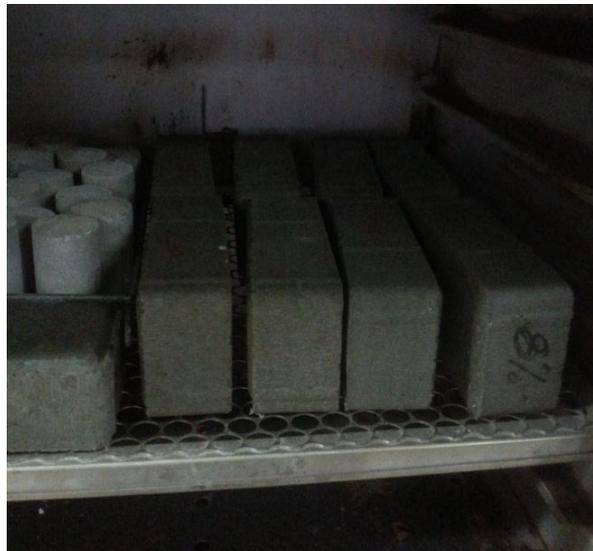
**Figura 41 - Corpos de prova na estufa**
