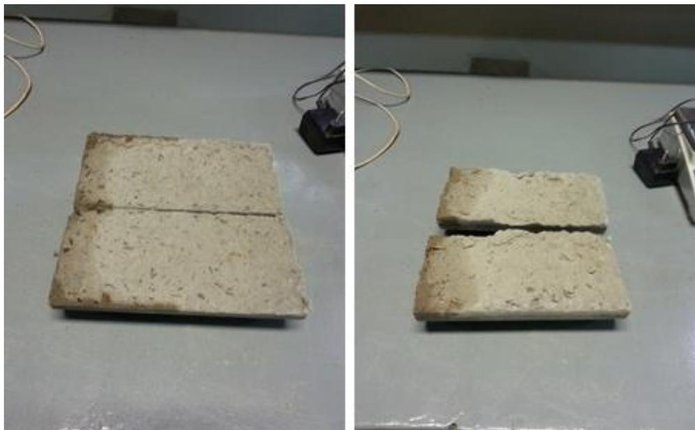
**Figura 46 - Distribuição de água no interior dos corpos de prova cilíndrico com concreto com adição de 5% de sílica ativa.**
