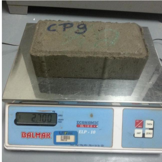
**Figura 40 - Pesagem do corpo de prova na condição saturado superfície seca**
