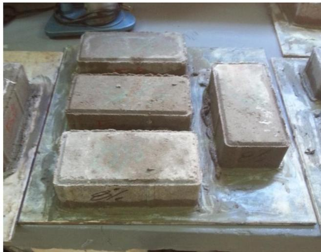
**Figura 39 - Corpos de prova depois de realizado o capeamento de um dos lados**
