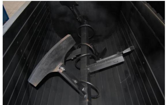
**Figura 23 - Misturador de eixo horizontal e suas hélices.**
