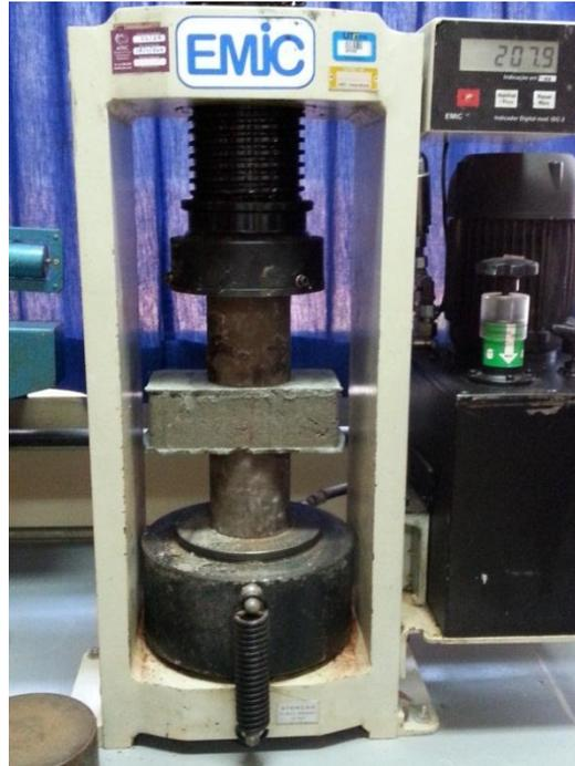
**Figura 38- Prensa hidráulica manual eletrônica**
