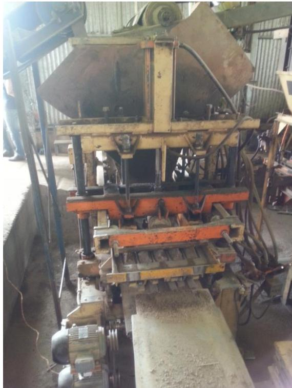
**Figura 28 - Máquina vibro compressão hidráulica.**
