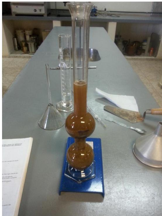
**Figura 34 - Ensaio de Massa Específica Real por meio do frasco Chapman**
