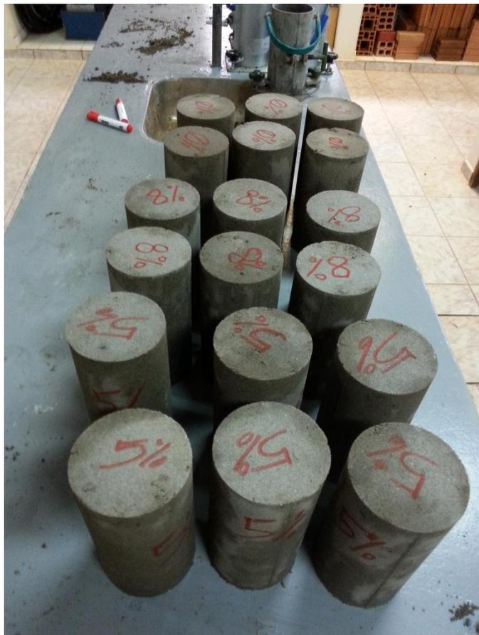
**Figura 32 - Corpos de prova cilíndricos depois de desmoldados e marcados segundo as adições.**
