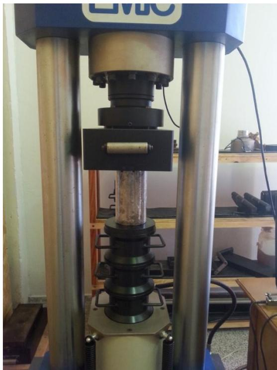
**Figura 42 - Prensa com os pratos carregamento o corpo de prova à ruptura à compressão**
