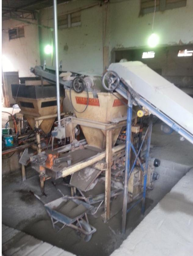
**Figura 26 - Vibro-prensa com esteira rolante**
