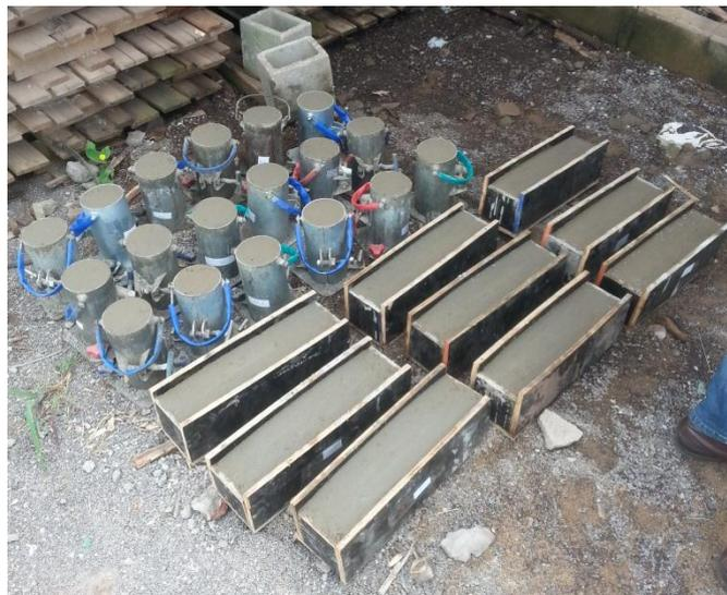
**Figura 31 - Corpos de prova após a moldagem**
