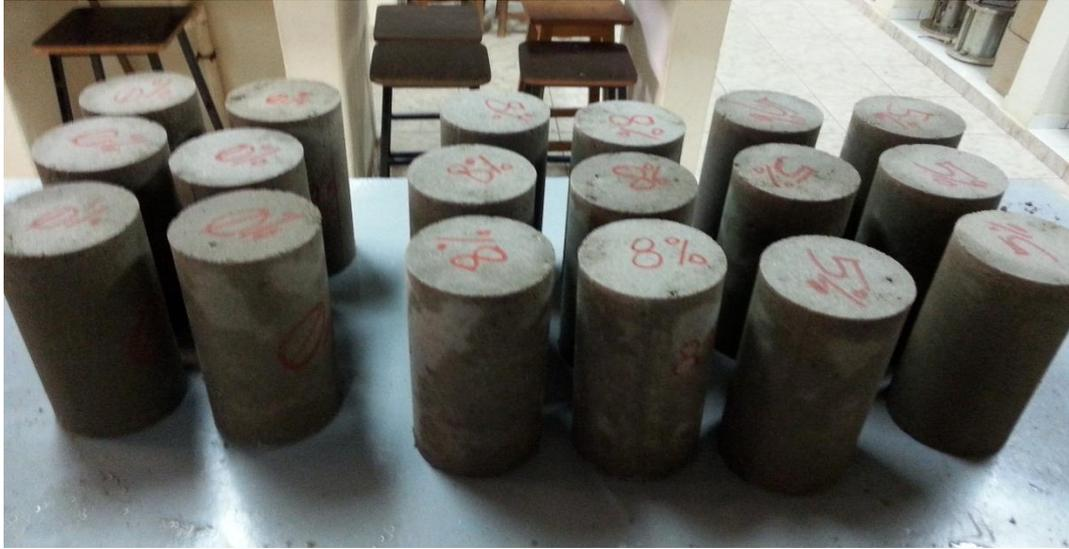
**Figura 33 - Corpos de prova cilíndricos depois de retidas as formas**
