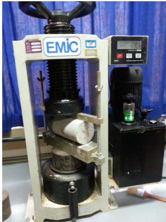
**Figura 44 - Ruptura dos corpos de prova por compressão diametral**
