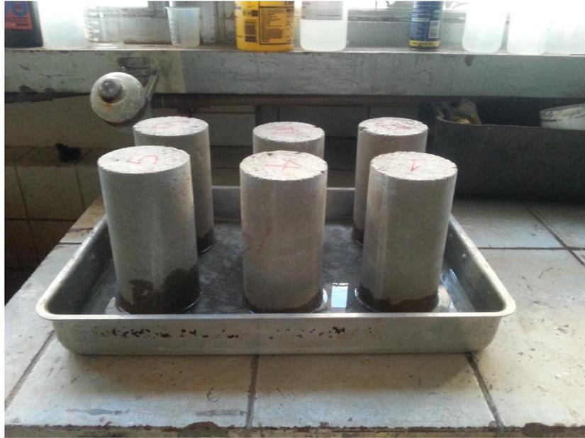
**Figura 43 - Badeira com superfície de 5 mm de água com corpos de prova para a obtenção da absorção de água por capilaridade**
