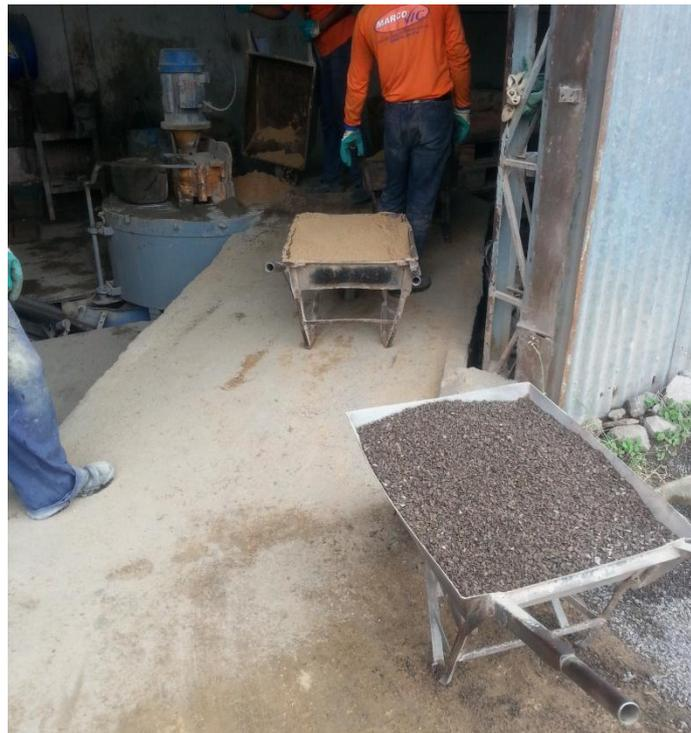
**Figura 25 - Entrada de materiais no misturador de eixo vertical.**
