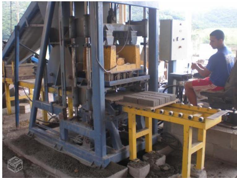
**Figura 24 - Blocos para pavimentação logo após a saída da vibro-presa**
