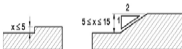
Figura 14 — Tratamento de desníveis Fonte: ABNT NBR 9050 (2004, p. 39)
