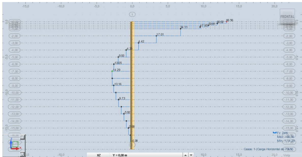
Figura 31- Diagrama de esforço cortante (kN) obtido no programa Robot .
