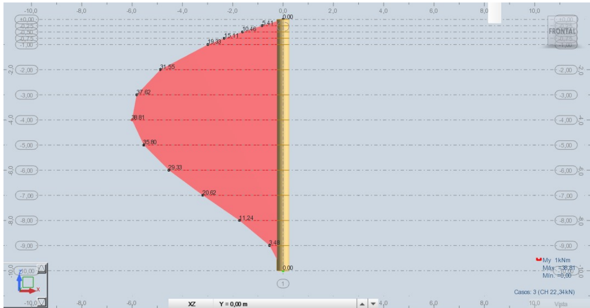
Figura 45- Diagrama de momento fletor (kN.m) para estaca imersa em solo estratificado.
