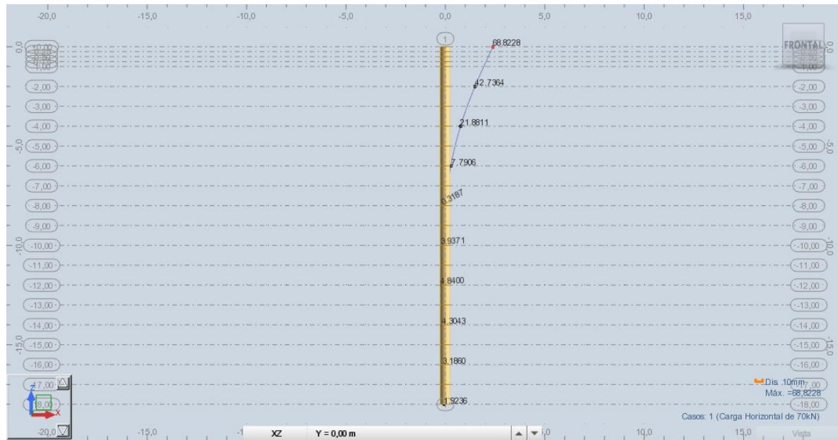
Figura 33- Diagrama de deslocamentos (mm) obtido no programa Robot .
