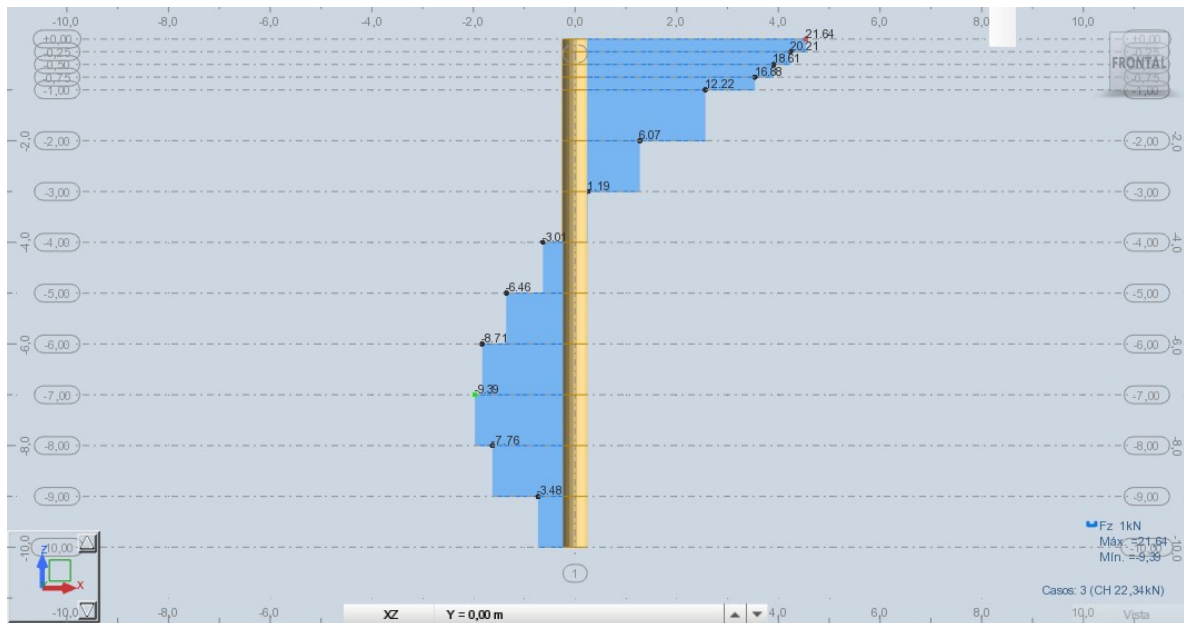
Figura 44- Diagrama de esforço cortante (kN) para estaca imersa em solo estratificado.
