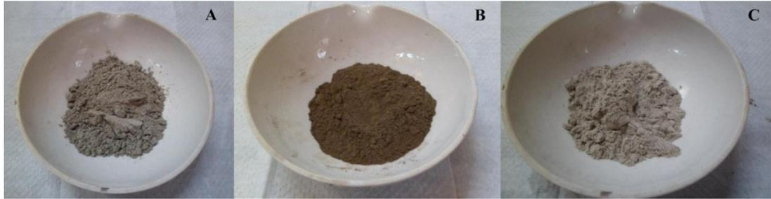
Figura 18 - Cimentos anidros, A - Cimento Portland, B - Cimento FONDU e C - Cimento Secar (51)
