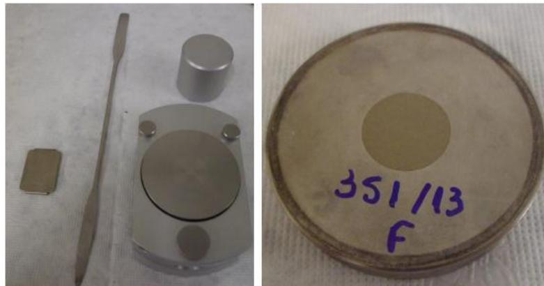
Figura 28 - Preparo amostras para ensaio de DRX.
