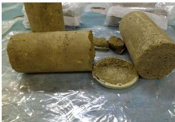
**Figura 74 - Imagem da argamassa contendo 2,5% de dicromato de potássio com 7 dias de hidratação.**
