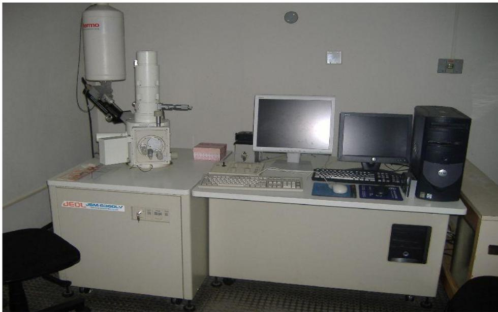
**Figura 30 - Equipamento MEV e EDS.**
