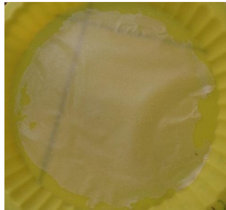
Figura 9 - Película contendo 75% de amido, 25% de gelatina e 2% de glicerol.
