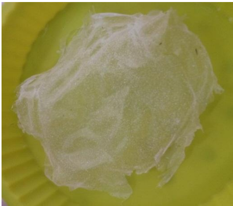
Figura 8 - Película contendo 100% de amido e 2% de glicerol.
