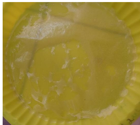
Figura 11 - Película contendo 25% de amido, 75% de gelatina e 2% de glicerol.
