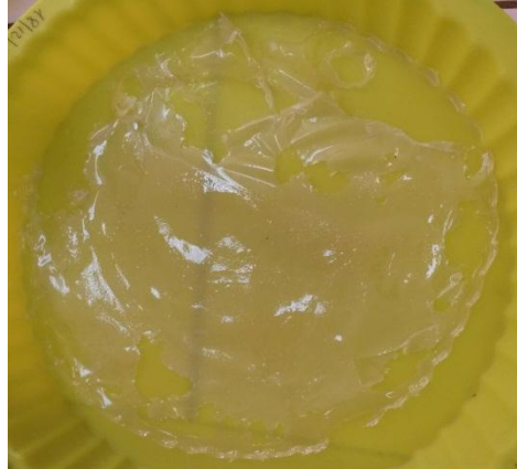
Figura 12 - Película contendo 100% de gelatina e 2% de glicerol.
