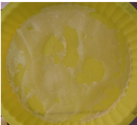
Figura 10 - Película contendo 50% de amido, 50% de gelatina e 2% de glicerol.
