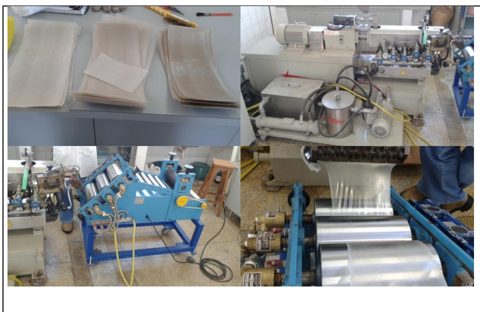
Figura 6. Elaboração dos laminados em extrusora dupla rosca acoplada a calandra.
