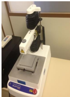
Figura 6 - Equipamento utilizado para o Teste de tração, TA-XT Express Enhanced Stable Micro Systems.
