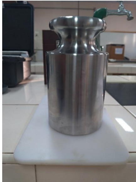
Figura 8 - Peso sobre o cubo de mortadela contido entre os papéis de filtro
