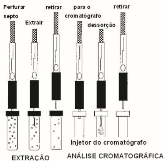
Figura 4. Representação do processo de extração do analito pelo material adsorvente (pela fibra) e dessorção do analito numa análise cromatográfica
