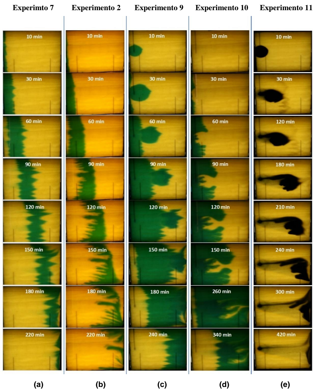
Figura 2 - Visualização do transporte 2D de LGB, CMC-Na e nZVI no aparato experimental (a) experimento 7 - Pulso de LGB; (b) experimento 2 - CMC-Na/LGB Pulso da mistura; (c) experimento 9 - Injeção pontual e pulso de LGB; (d) experimento 10 - Injeção pontual de CMC-Na e pulso de LGB; (e) experimento 11 - Injeção pontual de nZVI estabilizado em CMC-Na.
