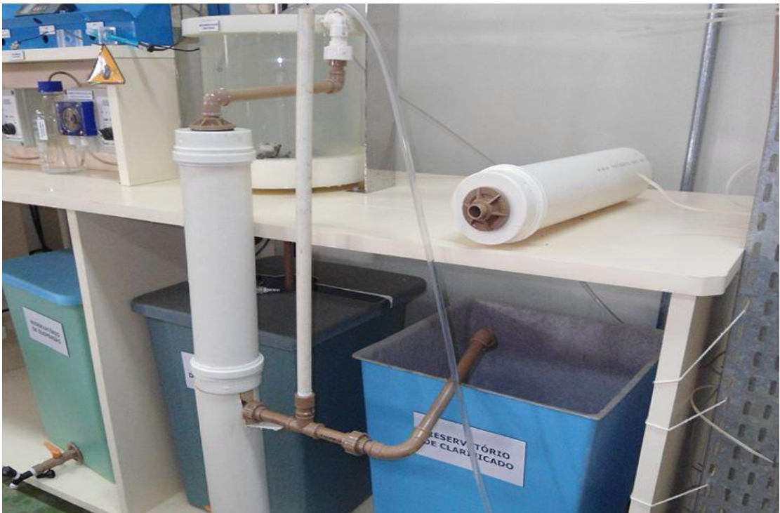
Figura 7 – Estrutura do filtro 2.
