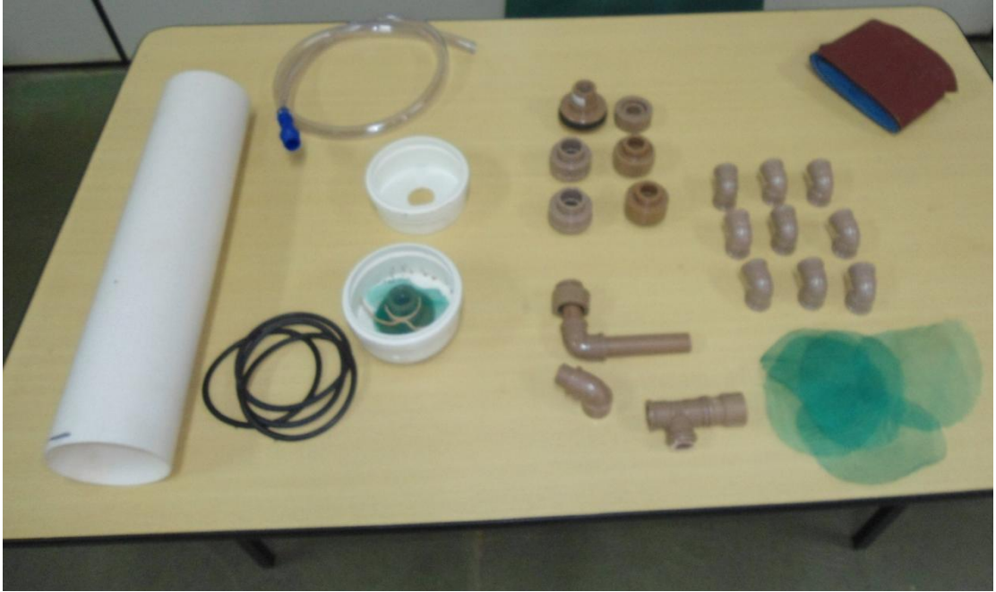
Figura 6 – Materiais utilizados para a construção do segundo filtro piloto.
