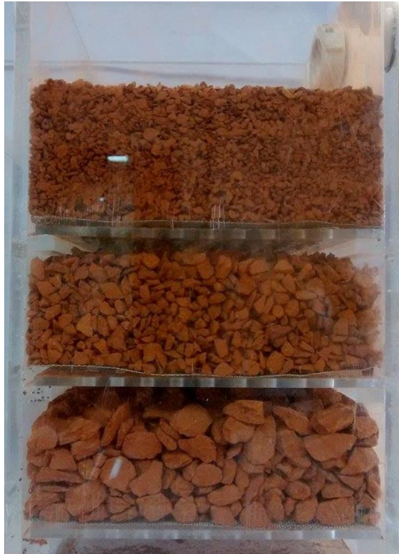
Figura 4– Disposição do material granulométrico separadamente no filtro 1 para os ensaios 1A e 1B.
