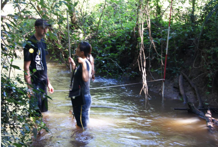
Figura 11. Determinação da vazão ao longo do canal utilizando o molinete fluviométrico de Newton.
