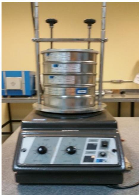
**Figura 2 - Agitador automático usado na análise de distribuição do tamanho de partículas**
