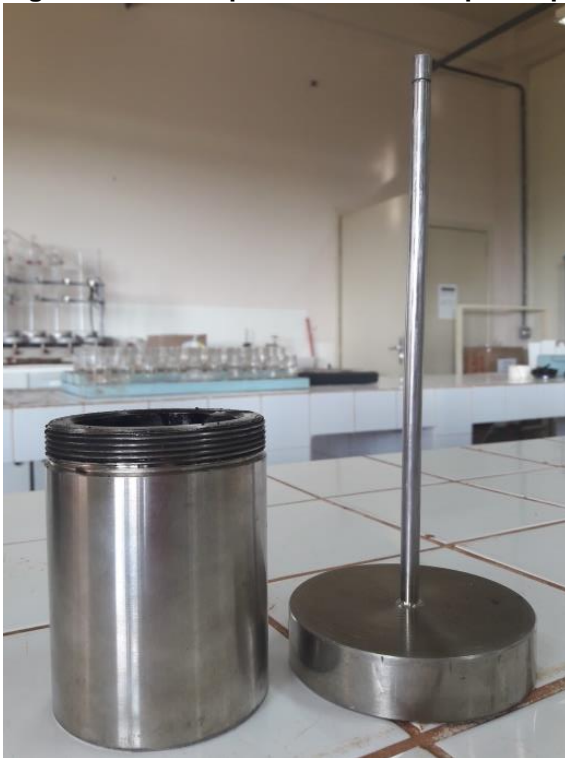
Figura 1 – Reator pirólítico utilizado para a produção de biochar e bio-óleo.
