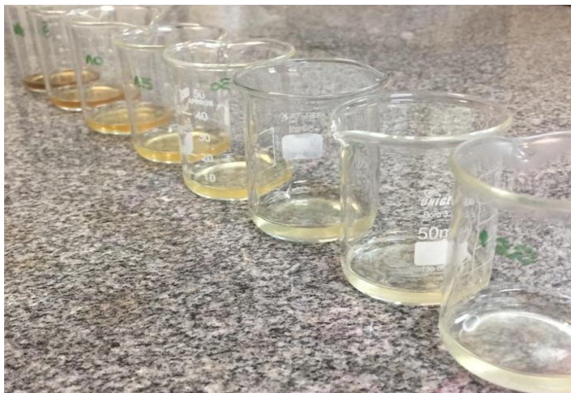
Figura 5 - Alíquotas referentes ao tratamento de lixiviado de aterro em pH 12,0.
