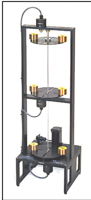
Figura 3: Planta didática torcional fabricada pela ECP. Fonte: Manual da ECP
