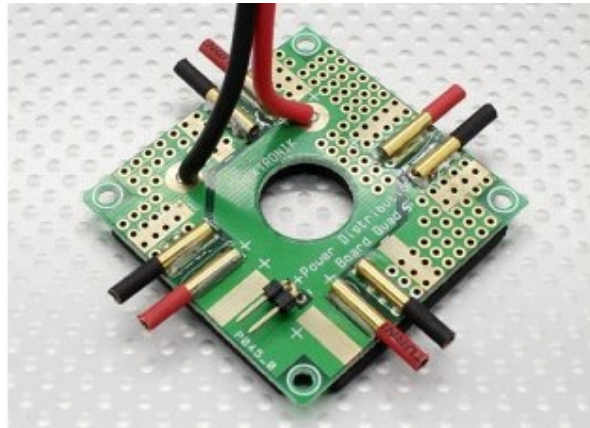
Figura 2.11 – Placa de Distribuição de Energia
