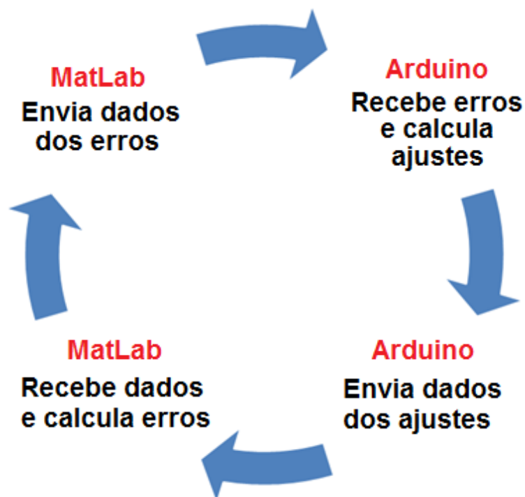
Figura 17 – Ciclo de comunicação Arduino-MatLab®
