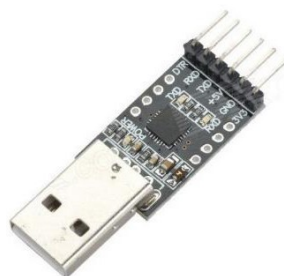
Figura 16 - Módulo Conversor USB TTL CP2102 Serial RS232
