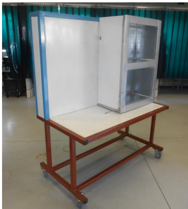
Figura 10 - Estrutura com as câmaras frigoríficas. Fonte: Autoria própria.
