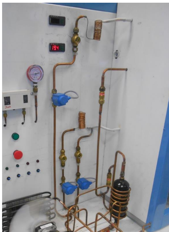
Figura 23 - Válvulas solenoide e dispositivos de expansão. Fonte: Autoria Própria.
