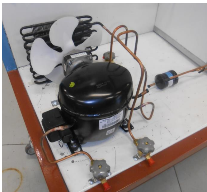
Figura 13 - Unidade condensadora. Fonte: Autoria própria.
