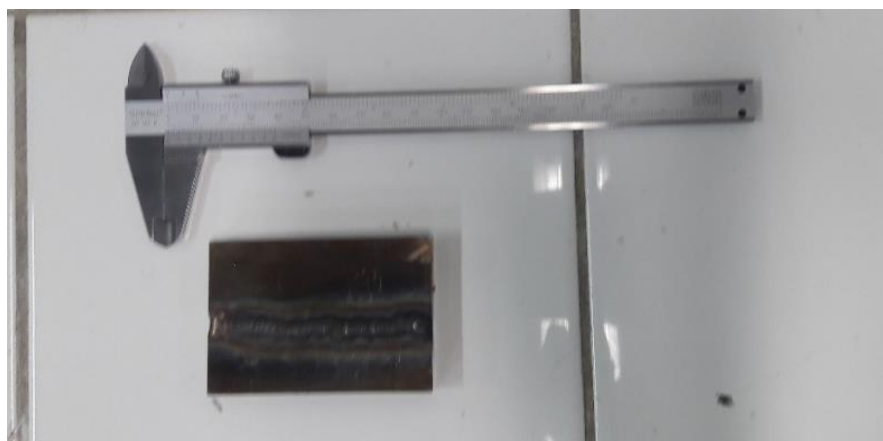
Figura 7: Corpo de prova depois de realizado o passe de soldagem Fonte: Autoria Propria
