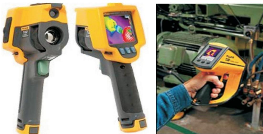
Figura 21. Equipamento para análise termográfica (Júnior, 2010).
