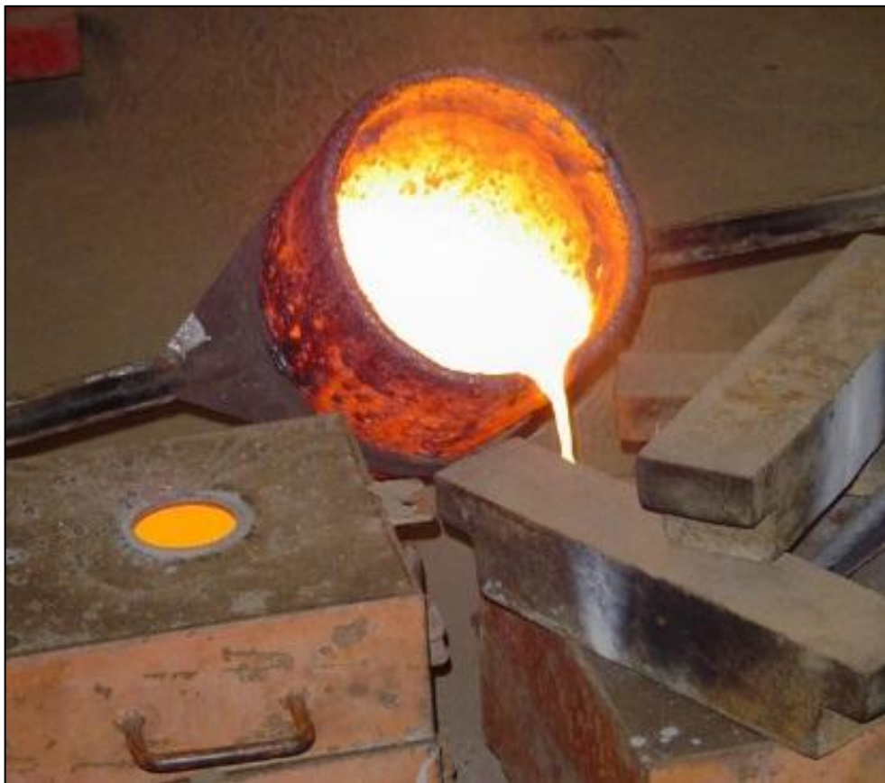
Figura 16 – Processo de Fundição da Engrenagem Fonte: Própria.
