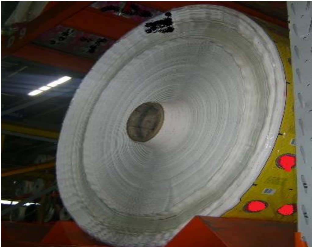
Figura 8: Bobina com problema de fenômeno telescópico.
