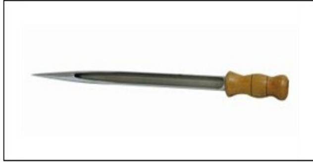
Figura A2 – Calador utilizado para fazer coleta de farinhas.
