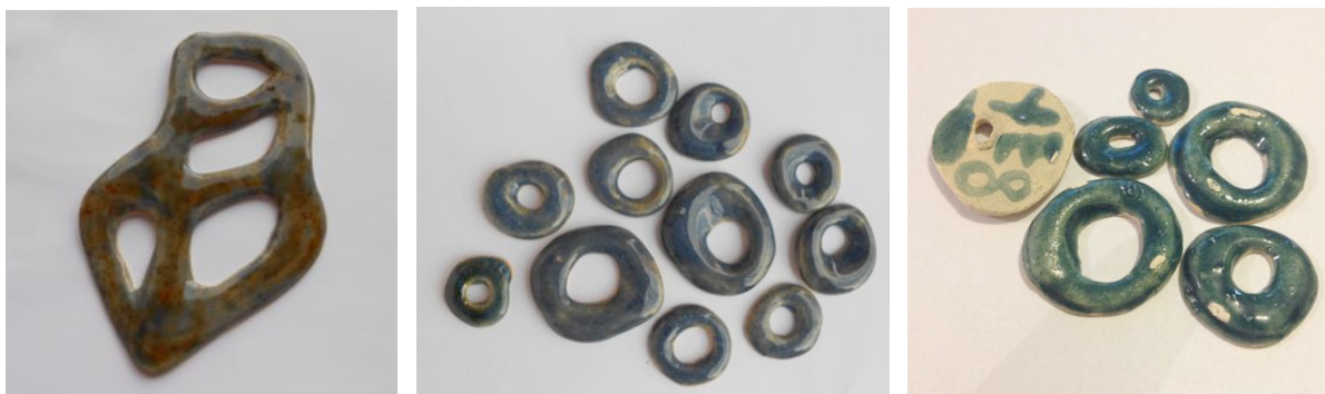
Figura 55 - Peças cerâmicas com problemas na esmaltação Fonte: autoria própria (2013)
