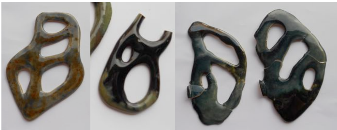
Figura 60 - Peças cerâmicas com problema de esmaltação e quebradas Fonte: Autoria própria (2013)
