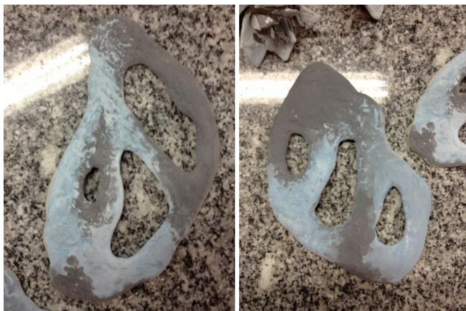
Figura 56 - Cerâmicas esmaltadas anterior à queima Fonte: autoria própria (2013)
