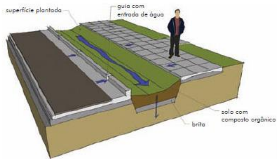
Figura 8 - Esquema de uma Valeta de Infiltração
