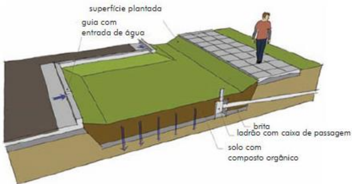
Figura 7 - Esquema de uma Superfície de Infiltração
