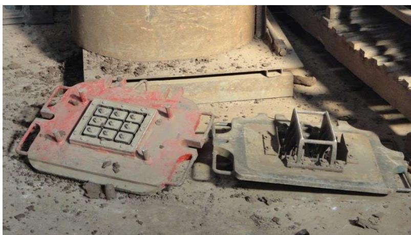
Figura 19: Moldes que definem o tamanho do bloco cerâmico Fonte: Acervo próprio.
