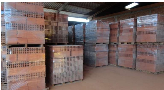
Figura 27: Blocos cerâmicos estocados Fonte: Acervo próprio.
