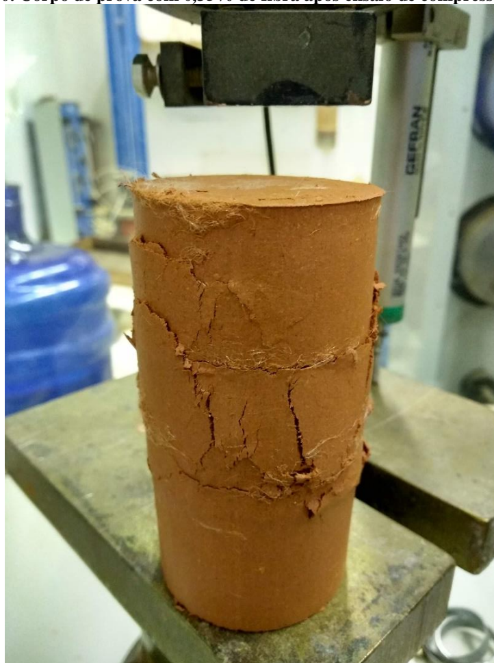
Figura 30. Corpo de prova com 0,35% de fibra após ensaio de compressão simples
