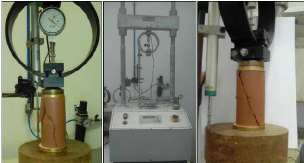
Figura 15. Máquina de Utilizada no Ensaio de compressão Direta e Exemplo de ensaio
