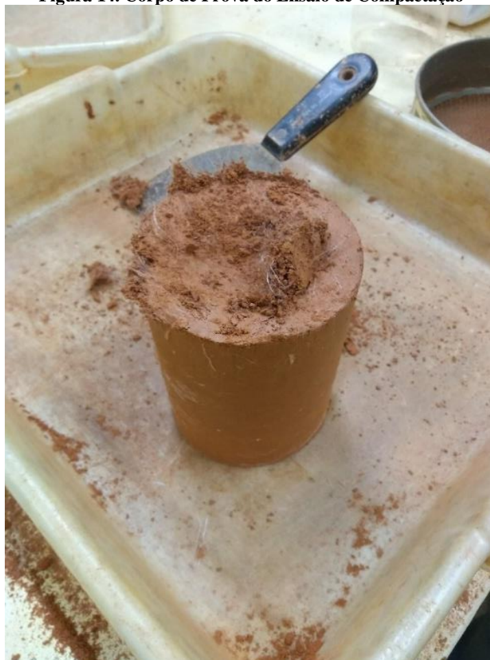
Figura 14. Corpo de Prova do Ensaio de Compactação
