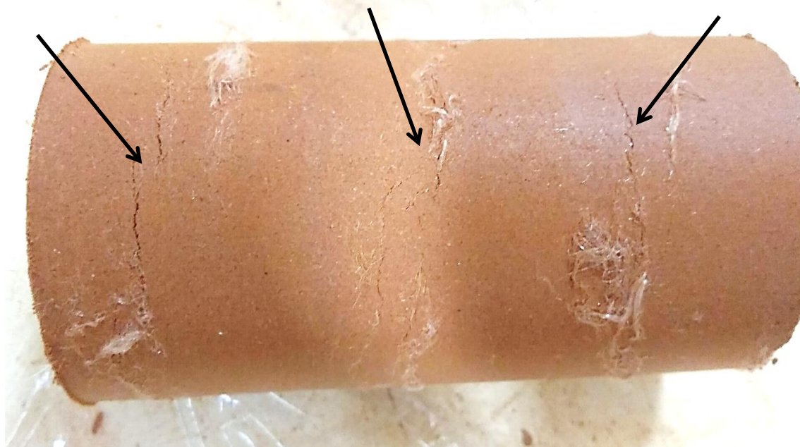
Figura 24. Fissuras formadas após moldagem em um corpo de prova com 0,50% de fibra.
