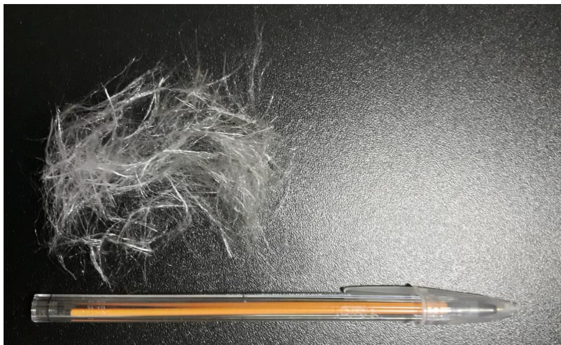
Figura 12. Fibra de polipropileno após desfiada
