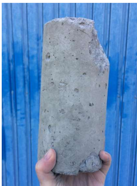
Figura 20 – Corpo de prova do agregado tratado com silano rompido após 7 dias Fonte: Autora, 2018.
