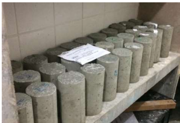
Figura 16 - Corpos de prova em câmara úmida aguardando a realização do ensaio Fonte: Autora, 2018.
