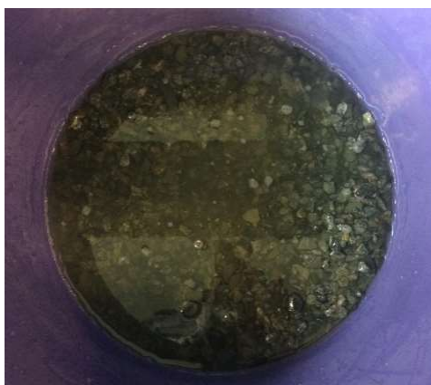
Figura 13 – Agregado graúdo em solução aquosa com tratamento de nanossílica Fonte: Autora, 2018.
