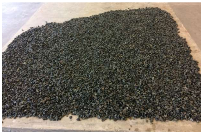
Figura 14 – Agregado graúdo secando em ambiente de laboratório após 24 horas imerso em solução aquosa Fonte: Autora, 2018.
