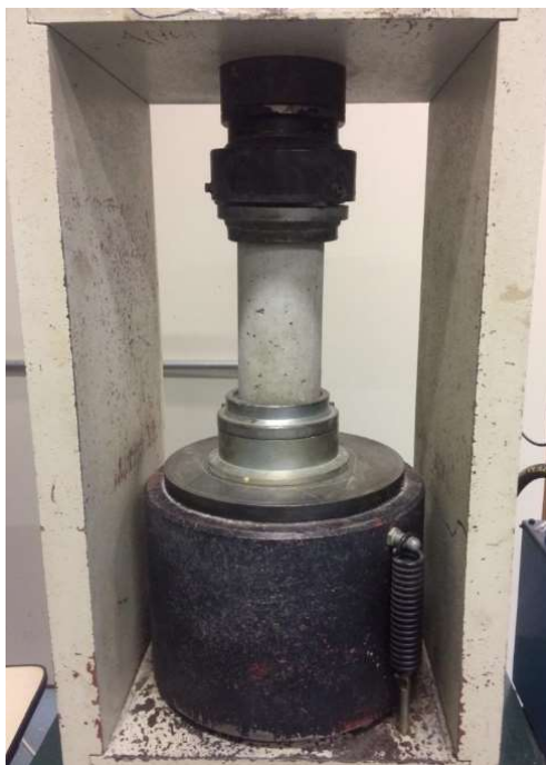
Figura 17 – Prensa para ensaio de resistência à compressão Fonte: Autora, 2018.
