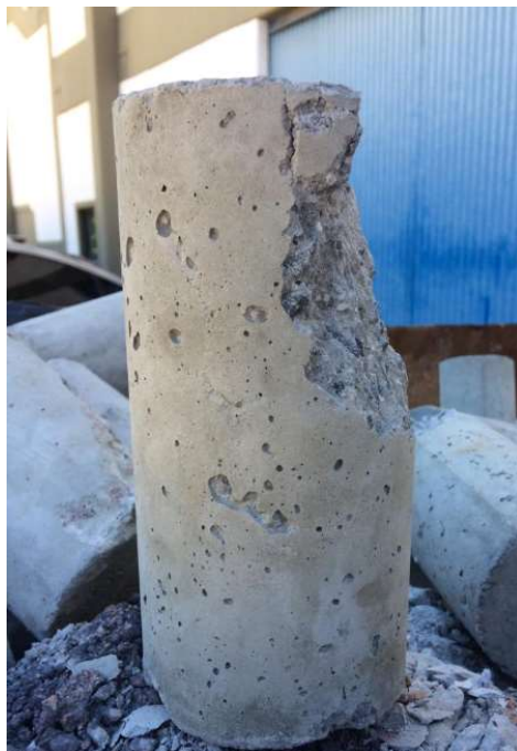
Figura 19 – Corpo de prova do agregado tratado com silano rompido após 3 dias Fonte: Autora, 2018.
