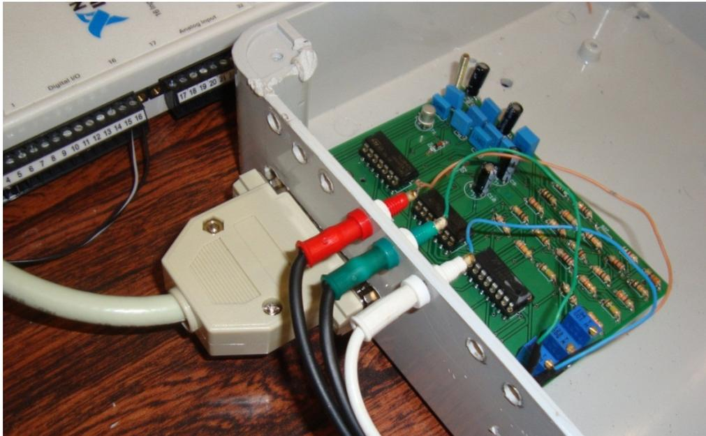
**Figura 13: Foto do circuito eletrônico desenvolvido para aquisição de dados do sensor óptico**
