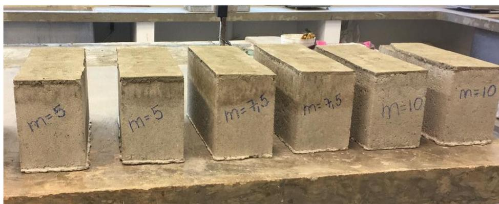
**Figura 20 – Capeamento dos blocos para ensaio aos 7 dias**
