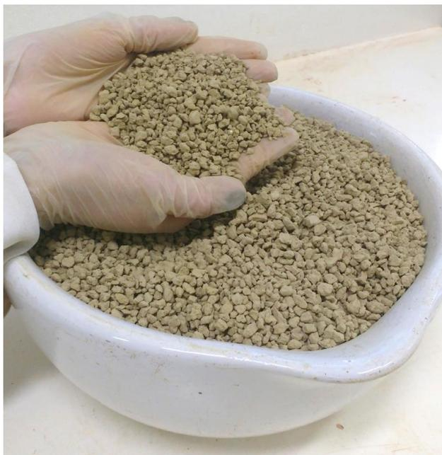
**Figura 25 - Material retido entre as peneiras de malha 4,76mm e 2,38mm**
