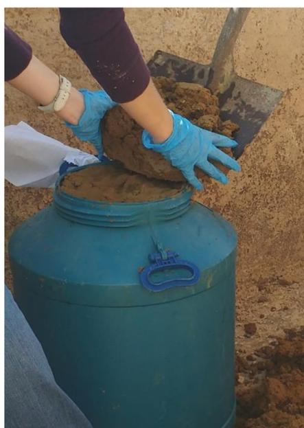
**Figura 13 – Armazenamento de lodo em bombona de 50L**
