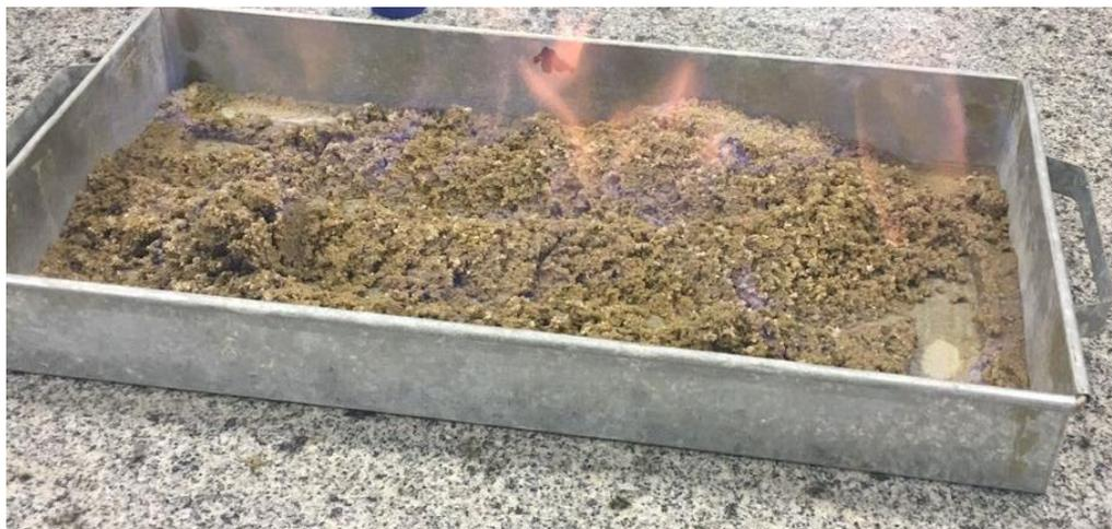
**Figura 18 – Secagem da areia com adição de álcool etílico**
