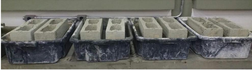
**Figura 26 - Blocos durante ensaio de absorção de água**
