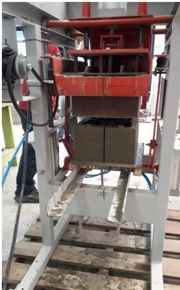
**Figura 21 - Vibro prensa utilizada para moldagem dos blocos**
