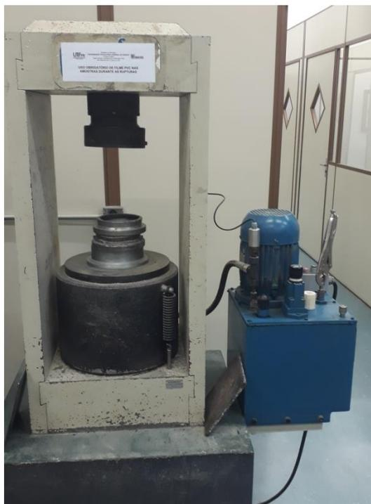
**Figura 19 - Prensa hidráulica EMIC PCE200**
