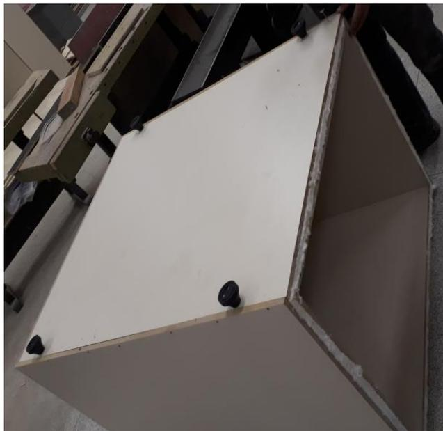
**Figura 34 - Fechamento e fixação dos suportes anti-vibração**
