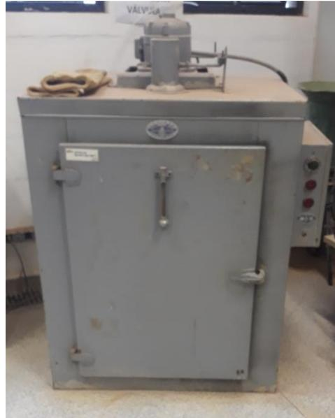
**Figura 23 - Estufa com ventilação**
