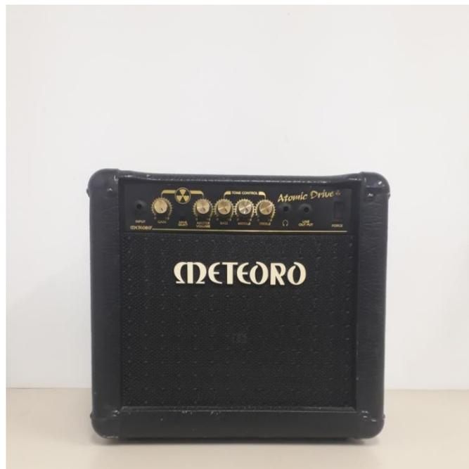
Figura 38- Fonte sonora utilizada no ensaio acústico
